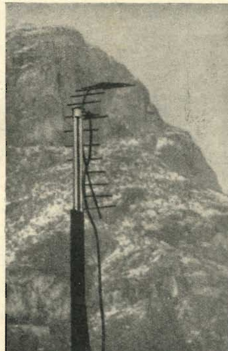
Le fotografie rappresentano una coppia di antenne paraboliche a spina di pesce per 1200 MHz (ponte radio sperimentale). A sinistra il terminale Sud, a destra quello Nord.
